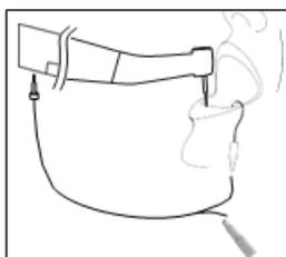
Подключитесь к совместимому апекс-локализатору, чтобы добавить функцию измерения канала<sup>7</sup>.
