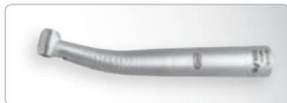
Компактный стеклянный световод, четырехточечный спрей Quattro Spray, мощность 21 Вт, диаметр головки 11,5 мм, кнопочный зажим для боров FG диаметром 1,6 мм, соединение Multiflex
