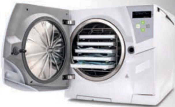
Стерилизатор W&H Lina –это водно-паровой стерилизатор класса В, для безопасной стерилизации твердых, полых и пористых изделий , в соответствии с EN13060.
