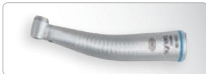
Угловой наконечник 1:1, одноточечный спрей Single Spray, компактный стеклянный световод, диаметр головки 9,5 мм, кнопочный зажим для боров для угловых наконечников диаметром 2,35 мм
