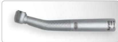
Компактный стеклянный световод, пятиточечный спрей, мощность 26 Вт, диаметр головки 13 мм, кнопочный зажим для боров FG диаметром 1,6 мм
