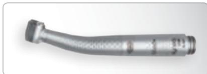
LED+, пятиточечный спрей, мощность 24 Вт, диаметр головки 11,5 мм, кнопочный зажим для боров FG диаметром 1,6 мм, быстросъемное соединение Roto Quick
