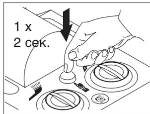
Нажмите кнопку программирования один раз, удерживая ее при этом в течение примерно 2 секунд. После процедуры обработки откройте купол.
