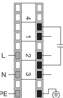
Рис. 1: Назначение клемм, 1-фазное устройство
