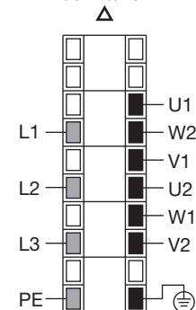
Рис. 2: Назначение клемм, 3-фазное устройство
