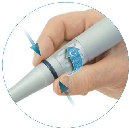
Высокая эргономичность камеры: настройка экстраоральной, интраоральной или макросъемки при помощи поворотного кольца IFC, управление при помощи запатентованного сенсорного кольца 360°
