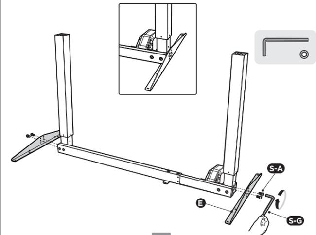
После затяжки винтов используйте сверло, чтобы сделать монтажные отверстия на обратной стороне столешницы через 8 отверстий на верхних опорах. **Внимание:** максимальная глубина отверстий 3 мм.
