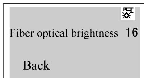
Знак на дисплее обозначает, что фиброоптика включена. С помощью кнопок «+» и «-» возможна настройка яркости фиброоптики.
