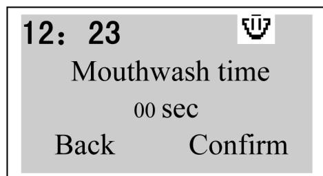
6.1.2.4. Установка времени омыва плевательницы: кнопками + или – выберите на дисплее нужный символ , нажмите на кнопку для входа в подменю. Повторно нажмите на эту кнопку и процесс омыва начнется. Для программирования желаемого времени омыва повторно нажмите на кнопку . На дисплее появится следующее изображение:
