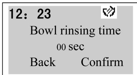
6.1.2.5 Установка одновременной функции омыва плевательницы и наполнения стакана пациента: кнопками + или – выберите нужный символ, нажмите на кнопку
