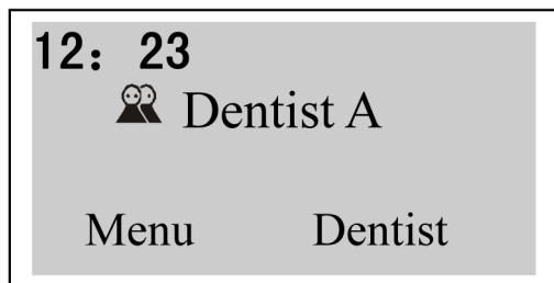
Выбор специалистов возможен нажатием кнопки «setting2». Для программирования кресла, установите кресло с помощью кнопок управления в желаемое положение. Нажмите кнопку «А» и удерживайте до звукового сигнала. После этого при однократном нажатии кнопки «А» кресло примет запрограммированное положение. Повторите вышеуказанные шаги для программирования позиций В и С.
