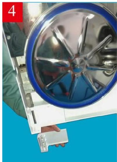
4. Ручку двери снять снизу.
