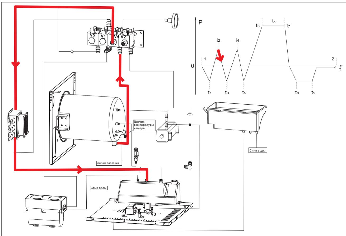
5. Работа вакуумного насоса
