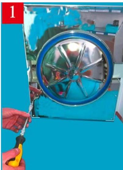
1. Снимите нижнюю часть металлической пластины.
