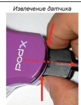
Рентгеновский датчик является дорогим и хрупким, а также подвержен воздействию статического электричества. Поэтому вынимайте его из интерфейса после отключения интерфейса.
