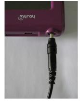
Зарядное устройство идет в комплекте с уже установленным гнездом в 4 мм. Гнездо имеет положительную полярность в центральном терминале.
