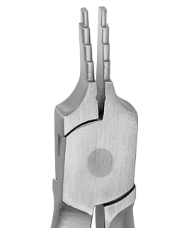
678-319 // Щипцы Nance для формирования петли. Обе щечки имеют закругленные рабочие части различного размера (3 мм, 4 мм, 5 мм, 6 мм) для точного изгиба закрывающих петель. Размер проволоки: \leq 0,022'' (0,53 мм)
