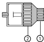
Динамометрический ключ служит для замены рабочих насадок SONICflex и для защиты от травм. Для ускорения ввинчивания рекомендуется брать динамометрический ключ в задней тонкой части ручки ①. Для затягивания и отпускания используется большой диаметр ②.
