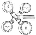
Для работы SONICflex требуется развиваемое давление не менее 2,5 бар (36 psi). Более высокое развиваемое давление автоматически уменьшается внутри SONICflex. Расход воздуха составляет около 26 - 33 норм. л/мин. Контрольный манометр (Арт. № 0.411.8731) установить между переходником MULTIflex и SONICflex.
