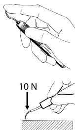
Может случиться, что вследствие длительной нагрузки или повреждения (падения на пол или механического изменения первоначальной формы) происходит разрушение. Поэтому перед каждым использованием легким нажатием большим или указательным пальцем проверять эксплуатационную надежность и безопасность насадки.
