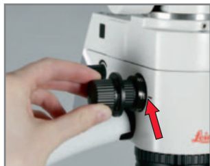
Регулятор увеличения с двух сторон, кратность: 6,4, 10, 16, 25, 40x
