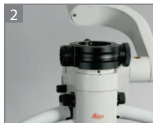
2 Установите светоделитель. Для наблюдения 50/50 % или 70/30 %.
