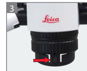
3 Наденьте защитное стекло на объектив. Выступ обращён вперёд (объективы точной фокусировки) или повернут на 90° влево/вправо (фиксированные объективы).
