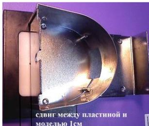
**Внимание:** У модели JT-20 смещение указателя лазера и сверла- не дефект. Модель выдвинута относительно пластины для штифтования вперед. Т.к. конструкция прибора исключает вращение модели (только перемещение вперед-назад, вправо-влево), то при работе осуществляется параллельный перенос разметки с модели на пластину( на 1 см), взаиморасположение штифтов сохраняется.
