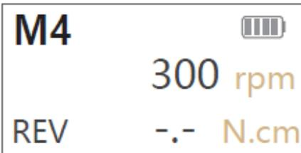
Мотор вращается только обратно на 360°. Обратный крутящий момент и другие функции не могут быть использованы одновременно.
