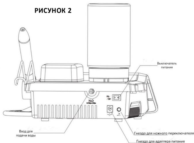
б) Подключение основного блока, ножного переключателя и адаптера
