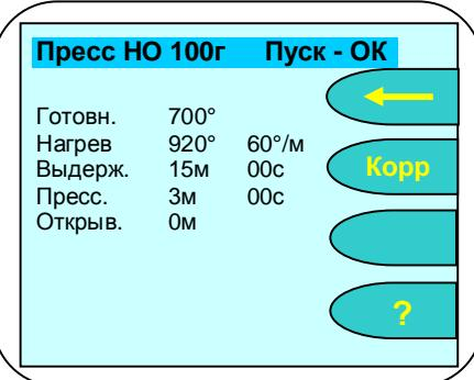
**Температура готовности** - ЭВП закрывает камеру и разогревается до 700 °С, затем камера открывается и ЭВП выводит приглашение **установить опоку** (в это время в камере поддерживается температура 700°C). После установки опоки нужно нажать **OK**. ЭВП закроется, включится вакуум.
