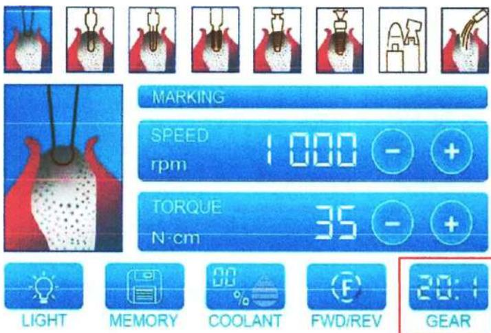
Отрегулируйте нажатием кнопки “GEAR” передаточное отношение для используемого наконечника.
