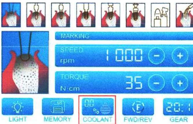
Нажмите кнопку управления ирригационным насосом “COOLANT” на экране для регулировки. Есть 6 уровней. Уровень воды увеличивается после каждого нажатия.
