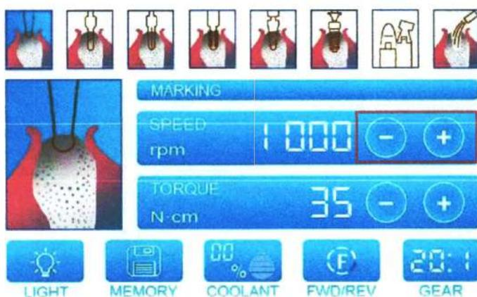
Нажмите кнопку «Speed» («Скорость») (+ / -), чтобы настроить скорость микромотора. Скорость будет меняться каждый раз после нажатия клавиши «Скорость». Длительное нажатие на кнопку «Скорость» ускорит изменение значения настройки скорости.
