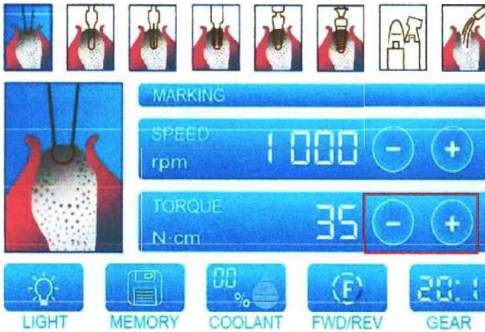
Нажмите кнопку “Torque” («Вращающий момент») (+ / -), чтобы настроить максимальный вращающийся момент микромотора. Вращающийся момент будет меняться каждый раз после нажатия клавиши «Вращающий момент». Длительное нажатие на кнопку «Вращающий момент» ускорит изменение значения настройки вращающего момента.
