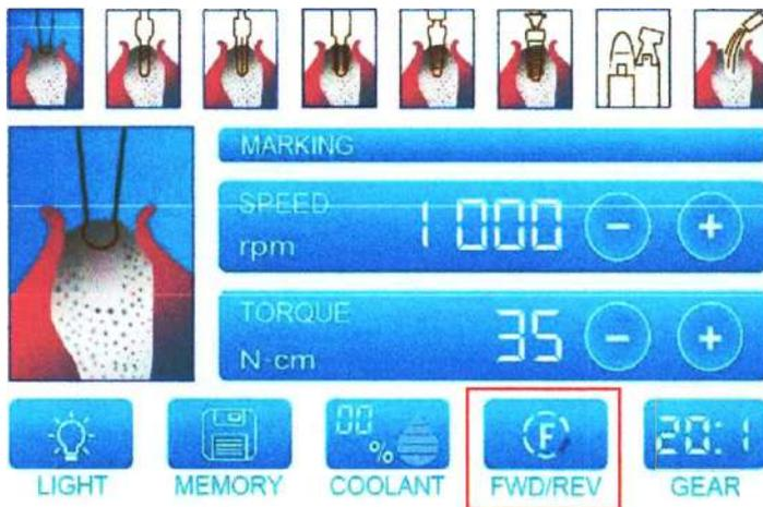
Нажмите кнопку, показанную на рисунке, чтобы изменить направление вращения микромотора.
