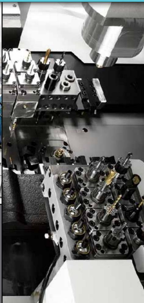
При производстве и тестировании наконечников используется только самое совершенное оборудование. Все детали и комплектующие для наконечников производятся на японских машинах TSUGAMI. Балансировку инструмента осуществляют немецкие балансировочные машины от компании SCHENCK. Оборудование для производства и тестирования вращающихся инструментов СОХО 2010-2011 года выпуска.
