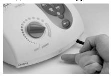
Перед тем как подключать шнур, убедитесь, что основной выключатель ON/OFF (ВКЛЮЧЕНО/ВЫКЛЮЧЕНО), расположенный в центре на нижней стороне системы, находится в положении OFF (O) (ВЫКЛЮЧЕНО).
