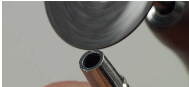
Эластичные и прочные, армированные стекловолокном диски предназначены специально для резки и шлифования супраконструкций имплантата из титана и титановых сплавов, таких как абатменты, балки и каркасы.
