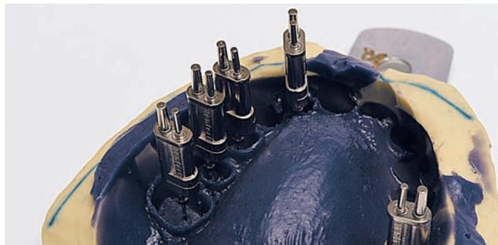
Штифт с блестящим никелевым покрытием и двумя направляющими. Специальный штекерный штифт для фиксации в слепке значительно сокращает время изготовления модели.
