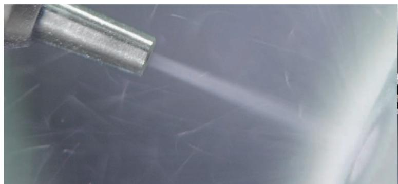
Комбинация из струйного средства и струйного сопла, а также оптимальная технология струйной обработки влияют на качество и скорость струйной обработки изделий.
