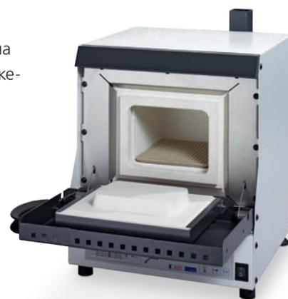
«Катализатор обезвреживает выхлопные газы, возникающие в процессе нагрева. Он легко прикрепляется к печи. При этом печь автоматически распознает подключение катализатора.»
