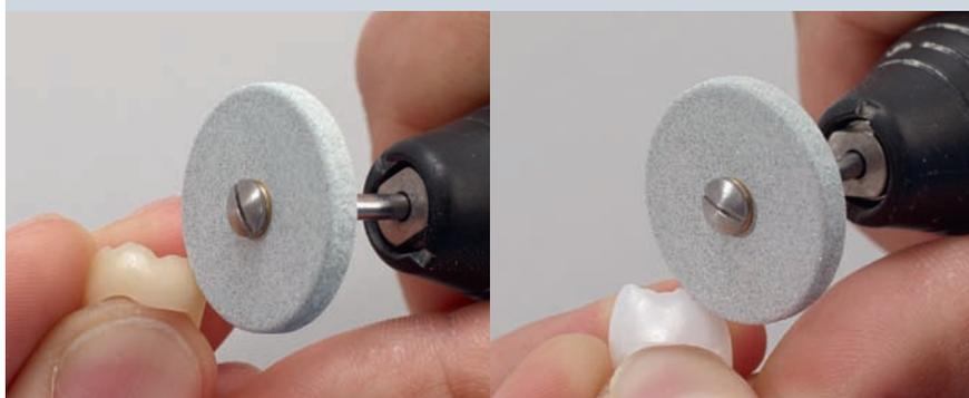
«Для предварительной полировки таких особо твердых материалов как дисиликат лития, оксид циркония, облицовочная и гибридная керамика, высокопрочные полимеры и облицовочные пластмассы, я использую силиконовый полир (Арт. № 86 0000). Быстрые и эффективные результаты зеркальной полировки обеспечены.»
