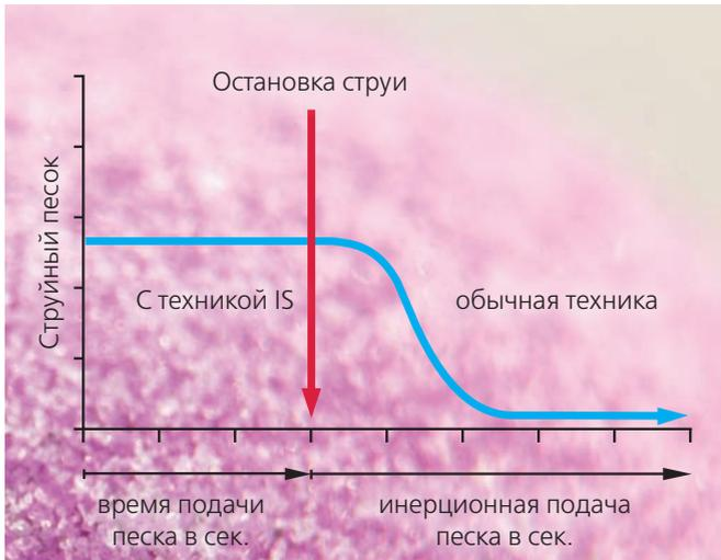
**Интегрированная функция мгновенной остановки струи IS (Immediate Stop)**
