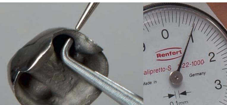
Измерительная система для точного определения толщины стенок зуботехнических изделий.
