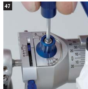
47 Прокрутите звёздчатый винт, чтобы открыть начальный боковой сдвиг (ISS). Резцовый штифт не должен касаться резового столика.
