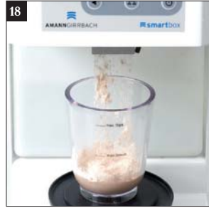
18 По нажатию кнопки «Smartbox» производит дозированную подачу воды и гипса.
