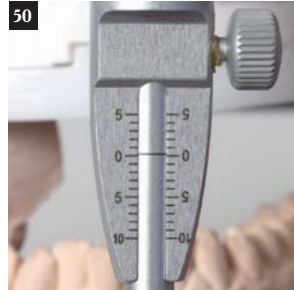
50 Вертикальный опорный резцовый штифт опустить до контакта с резцовым столиком. Новая рекомендованная высота работы найдена. Показания на резцовом штифте изменились.
