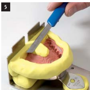
Помещённый вокруг оттиска вал из «Giroform Putty» обрезать параллельно верхнему краю подставки для оттисков.
