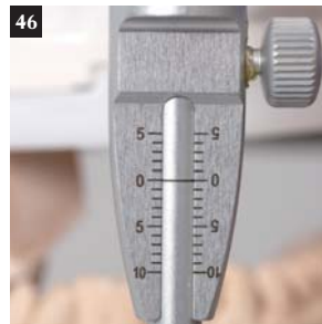
46 Резцовый штифт установлен на нулевую отметку и касается резового столика, при этом артикулятор зафиксирован в центральном соотношении.
