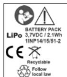
Vær oppmerksom på at litium-polymer-batterier kan reagere med eksplosjon, brann og røykutvikling ved ukorrekt behandling eller ved mekaniske skader. Fortsatt bruk av skadde litium-polymer-batterier er ikke tillatt.
