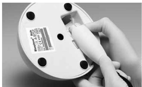
Τοποθετήστε το ρευματολήπτη σύνδεσης κατευθείαν μέσα στο τεμάχιο χειρός μέχρι να ακούσετε και να αισθανθείτε ότι έχει ασφαλίσει.
