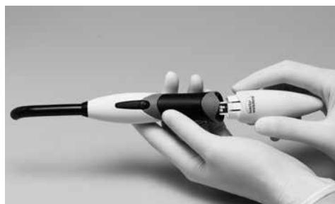
Sett håndstykket forsiktig inn i åpningen i ladestasjonen. Hvis det blir brukt en hygienebeskyttelse, må denne fjernes før batteriet lades opp. Om mulig skal apparatet alltid brukes med et fullt oppladet batteri - dette forlenger levetiden. Det anbefales derfor å sette håndsettet i ladestasjonen etter hver pasient. Ladetiden varer to timer når batteriet er tomt.
