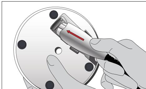
Podłączyć kabel zasilacza do sieci i do zasilacza. Lampka na zasilaczu zaświeci na zielono i zapali się na krótko okrągły sygnalizator na ładowarce.
