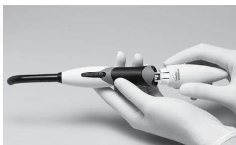
Placera försiktigt handstycket i det avsedda urtaget på laddningsstationen utan att använda kraft. Om ett hygienskydd används ska det avlägsnas innan du laddar batteriet. Använd alltid lampan med fulladdat batteri, om möjligt, eftersom det kommer att förlänga lampans arbetsdugliga livslängd. Vi rekommenderar därför att handstycket åter placeras i laddningsstationen efter varje patient. Laddningstiden för ett helt tomt batteri är 2 timmar.
