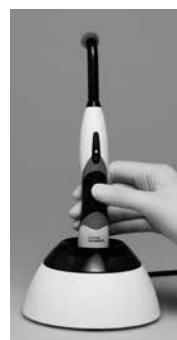
De batterij is een onderdeel dat regelmatig moet worden vervangen. Meestal gebeurt dit na ca. 2½ jaar. Op het etiket van de batterij staat de precieze productiedatum van de batterij.
