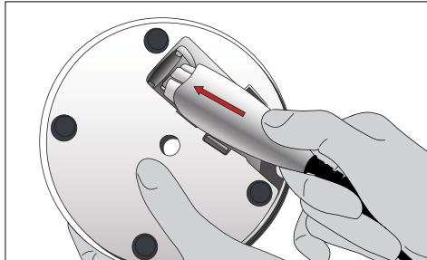
Koble strømkabelen til forsyningsnettet og forbind den med nettapparatet. Power On-indikatoren på nettapparatet tennes og lyser grønt og den tente ringen på ladebasen lyser kort.
