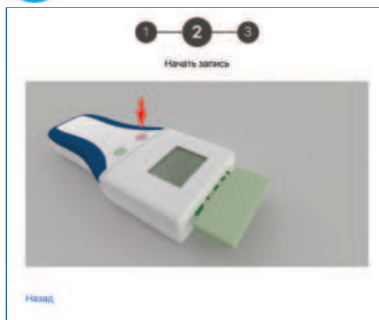
Рис. 21. Второй шаг: нажмите левую кнопку (розового цвета), вставьте тестовый сенсор в портативное устройство, чтобы начать тест
