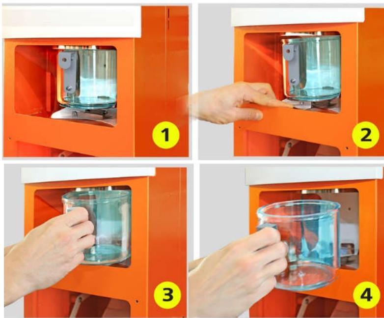
7.5 Для выработки полного ресурса воздуховсасывающего агрегата рекомендуется после гарантийного срока (6 месяцев, см.п.10.2) и регулярно в дальнейшей эксплуатации проверять отсутствие пыли, грязи.
