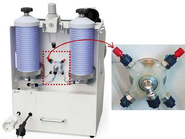
**Пример с АСОЗ АРТ КАСТ:** подключите **долото** к штуцеру пневмораспределителя.
