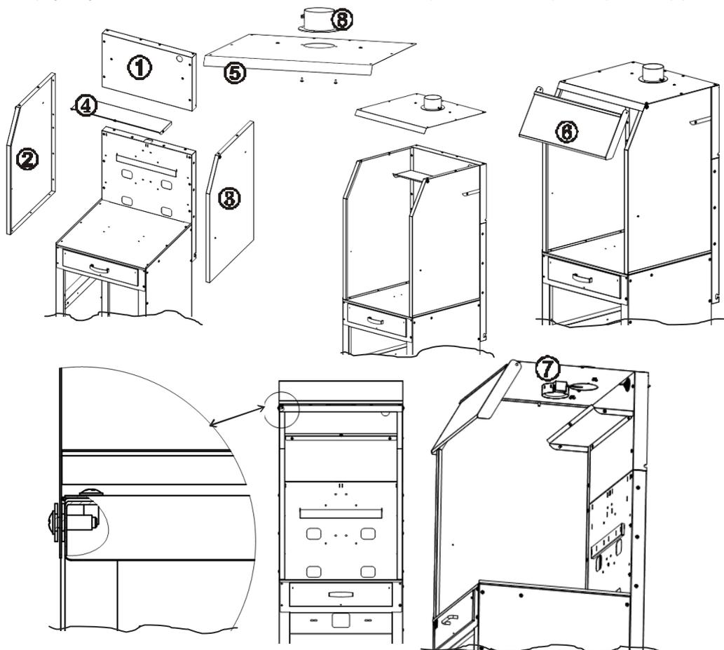
Осями откидной крышки (6) являются винты M5x35. Головка винта должна располагаться с внешней стороны зонта. На рисунке изображено правильное расположение крепежа.
