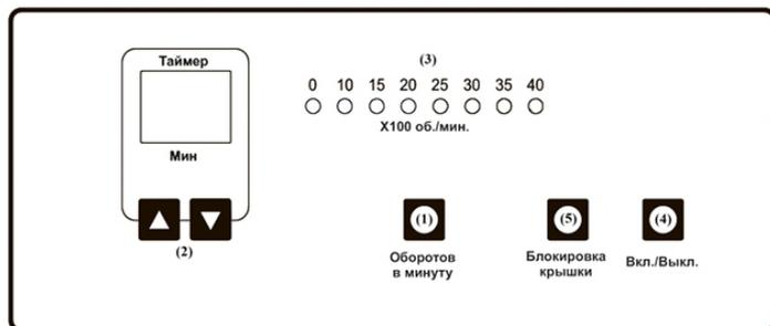
Рис. 1 – Схема элементов управления центрифуги LC-04A:
