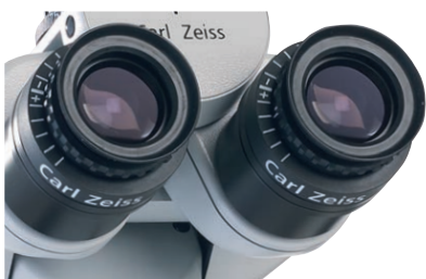
Широкопольные окуляры обеспечивают большую глубину резкости, а стереоскопичная база объемное изображение. Специальные наглазники с диоптрийной компенсацией позволяют работать на микроскопе докторам в очках или без очков.
