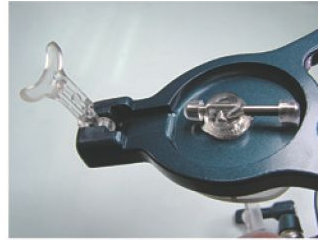
В случае необходимости, Вы можете изменить позицию нижней пластины, ослабляя ручку
